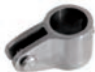
Forcella per tubo con vite in acciaio AISI 316 204-1315 Ø 22mm 204-1316 Ø 25mm 204-1317 Ø 30mm 204-1317HV Ø 30mm (più massiccia)
